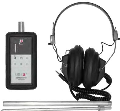
Le détecteur vous permet d'entendre des sons presque inaudibles. Il vous aide à détecter les fuites des circuits sous pression. Pressurisez le circuit avec de l'azote à une pression entre 10 et 17.5 bars et ensuite écoutez pour situer la fuite.
