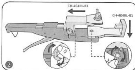
2 Mettre en place les supports inférieur et supérieur.
