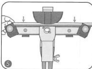
5 Mettre en place le tube, positionner les galets et amener la tige en butée.
