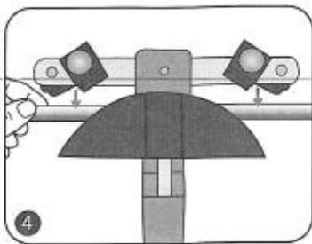
Mettre en place le tube, positionner les galets et amener la tige en butée.
