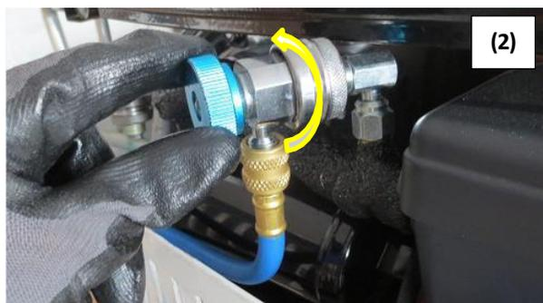
Les flexibles de la station sont isolés du **circuit A/C**.
