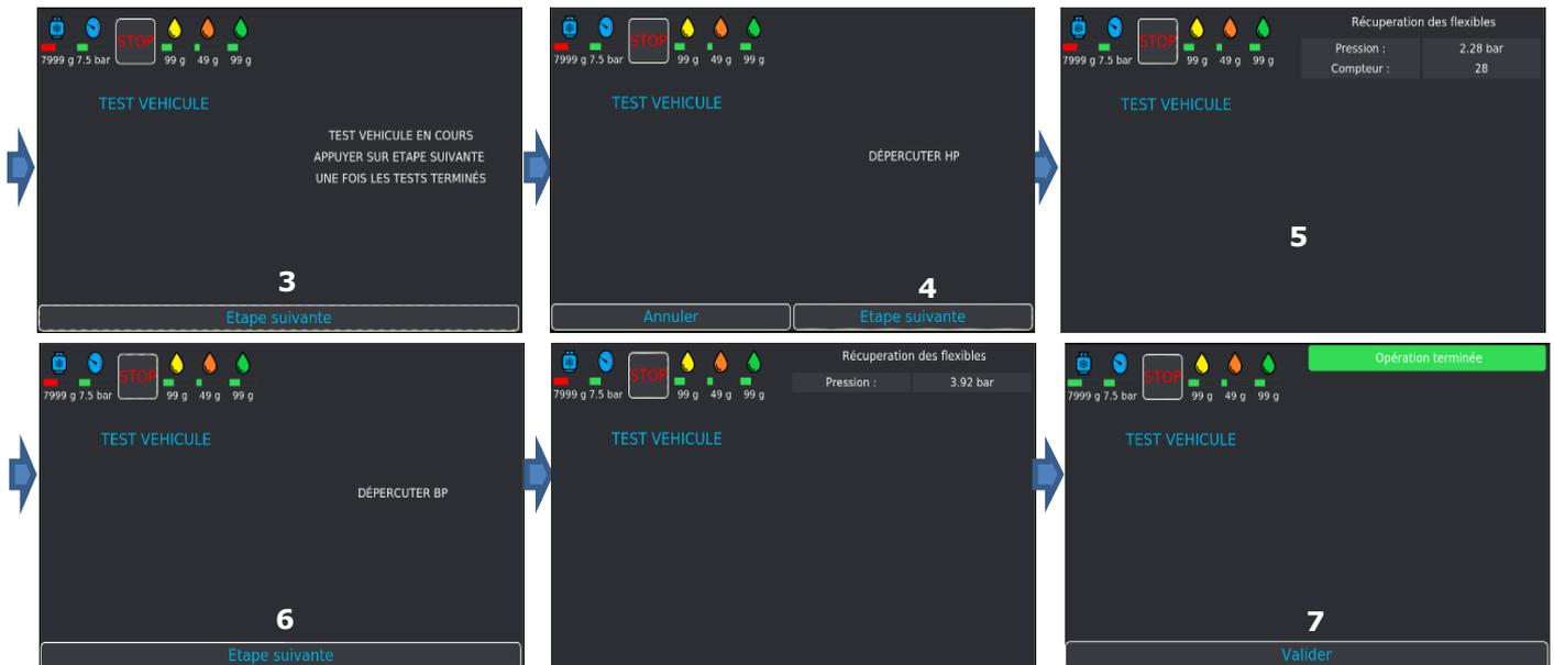
Brancher les flexibles **HP** et **LP** de la station sur les prises de charge du circuit A/C **(a)**, et visser les molettes des coupleurs **(b)**. Continuer avec **Etape suivante (1)**.
