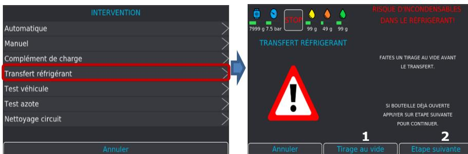
*Il est recommandé de faire un tirage au vide avant une opération de transfert de réfrigérant R134a dans la bouteille de la station afin d'éviter les incondensables dans le réfrigérant R134a.*
