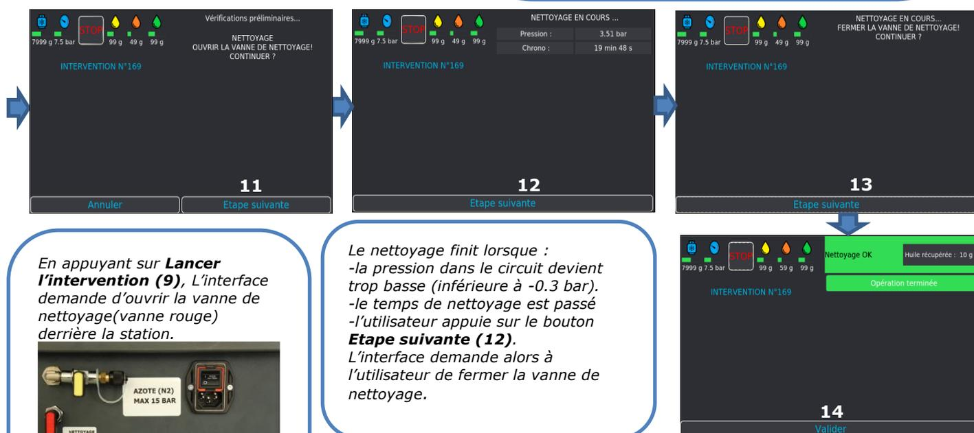
En appuyant sur **Lancer l'intervention (9)**, L'interface demande d'ouvrir la vanne de nettoyage (vanne rouge) derrière la station.
