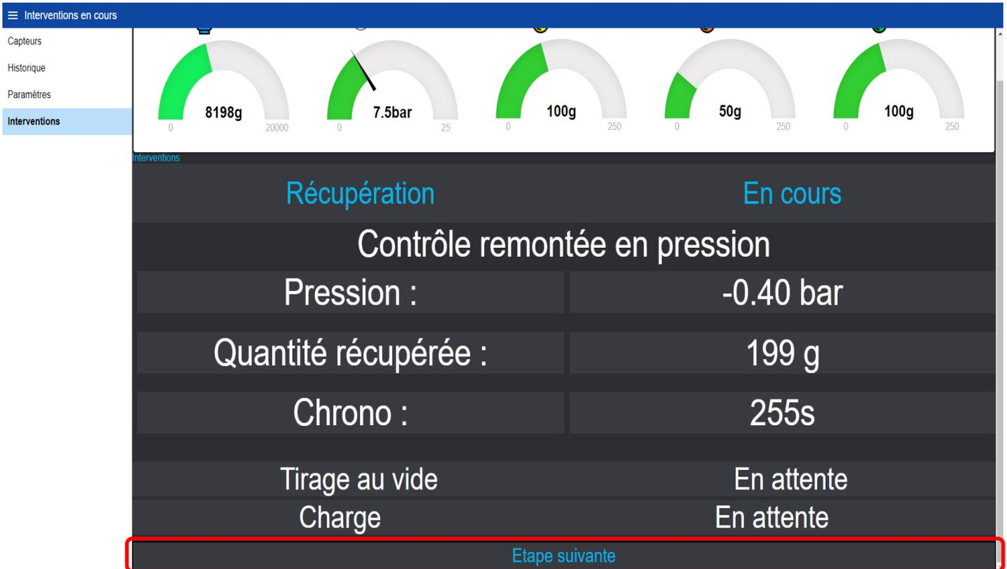
Exemple de bouton pour agir à distance sur station : l'appui sur ce bouton passera l'étape du contrôle remontée en pression
