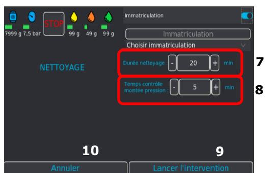
Par défaut, la durée du nettoyage est de 20 minutes. Ce paramètre (**1067**) est modifiable dans le menu **Paramètres** (voir chapitre **8.12.1**)
