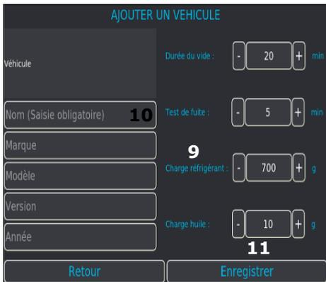
Dans le sous **menu Véhicules utilisateur (1)**, l'utilisateur peut créer sa propre base de données véhicules.
