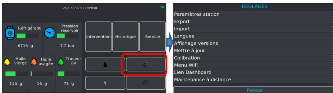
Le menu **Réglages** permet de modifier les paramètres utilisateurs de sa station, d'importer et/ou exporter ses bases de données mettre à jour sa machine par intrusion d'une clé USB, étalonner les capteurs, la connecter à un réseau wifi...
