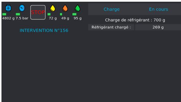
Avant de démarrer la charge, la station initialise la balance et vérifie que la mesure est stable. Si la station est soumise à des mouvements, cette stabilisation peut prendre un certain temps à cause du ballonnement du liquide dans le réservoir.
