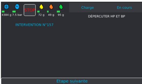
Dévisser les molettes des coupleurs **HP** et **BP** pour isoler les flexibles du circuit A/C. Puis, valider avec **Etape suivante**.
