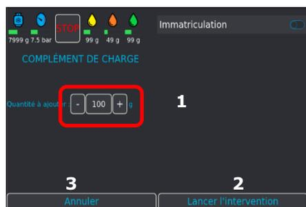
Par défaut, la quantité de charge est de 100 grammes. Ce paramètre (**1065**) est modifiable dans le menu **Paramètres** (voir chapitre **8.12.1**)
