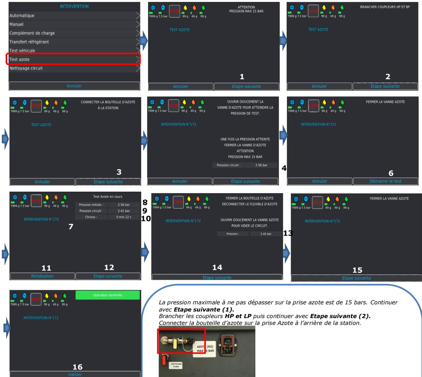
La pression maximale à ne pas dépasser sur la prise azote est de 15 bars. Continuer avec **Etape suivante (1)**.
