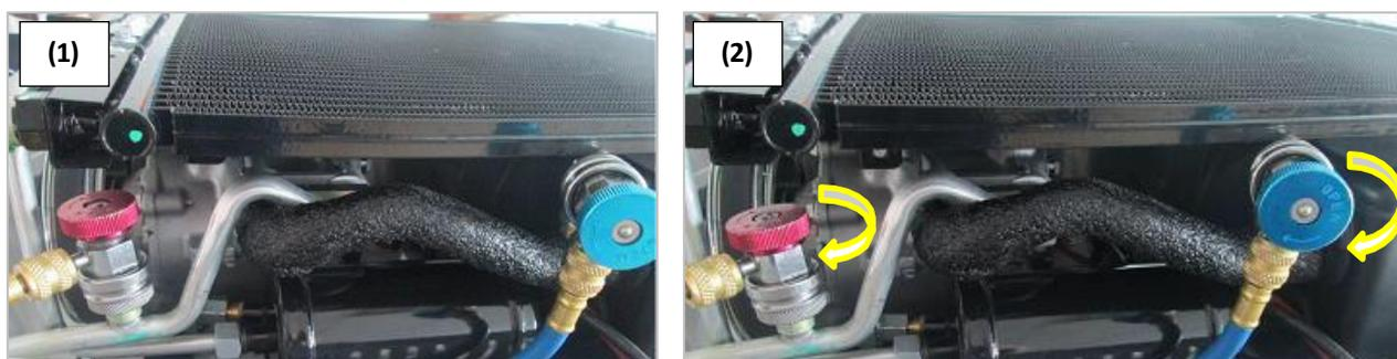
Les manomètres **HP** et **BP** indiquent la pression du circuit A/C.
