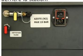
Après ouverture de la vanne de nettoyage, continuer l'opération en appuyant sur **Etape suivante (11)**. La station démarre le nettoyage. Pendant l'opération de nettoyage, la station récupère du réfrigérant en permanence. La pression dans le circuit et le temps de nettoyage restant figurent sur l'écran.
