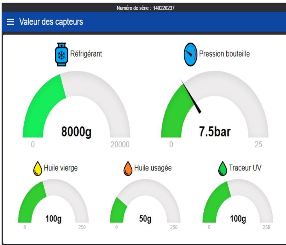
Cet onglet permet de visualiser en temps réel les valeurs respectives des capteurs principaux de la station.
