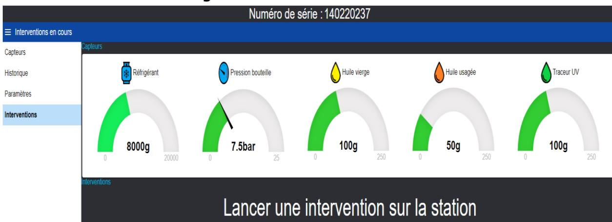
Cet onglet reproduit l'affichage de l'interface tactile de la station lors d'une opération, pour pouvoir surveiller les étapes d'une intervention sans être à côté de la machine.
